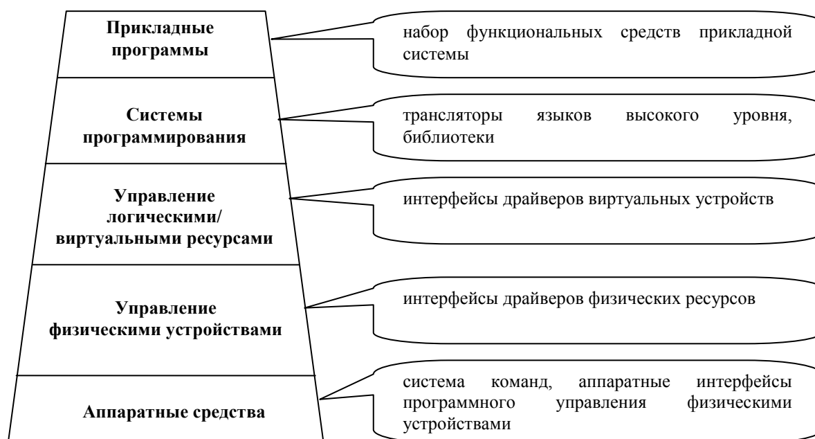
Рис. 19. Структура организации вычислительной системы.
