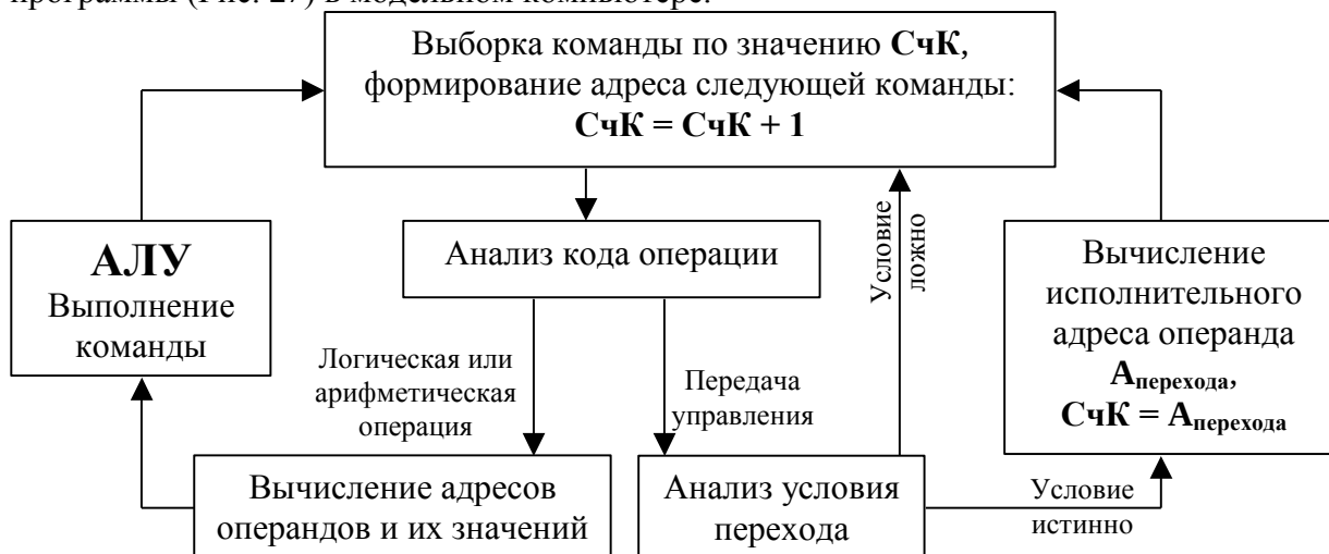
Рис. 27. Алгоритм выполнения процессором программы (рабочий цикл ЦП).
