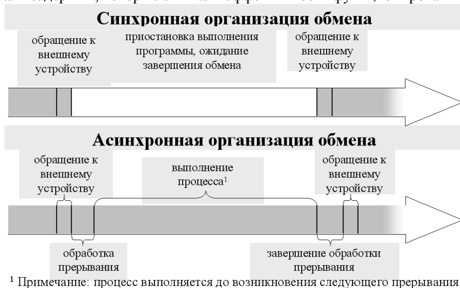
Рис. 39. Синхронная и асинхронная работа с ВУ.
