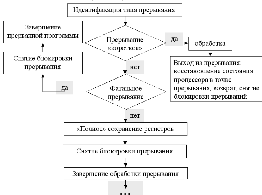
Рис. 33. Программный этап обработки прерываний.
