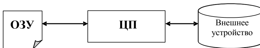
Рис. 40. Непосредственное управление внешними устройствами центральным процессором.
