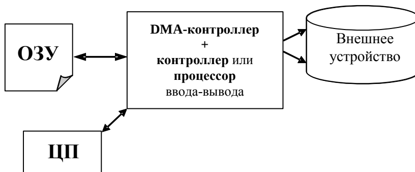
Рис. 42. Использование контроллера прямого доступа к памяти (DMA) или процессора (канала) ввода-вывода при обмене.
