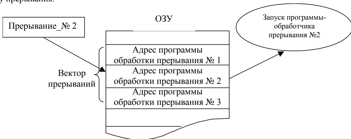
Рис. 31. Модель организации прерываний с использованием «вектора прерываний».
